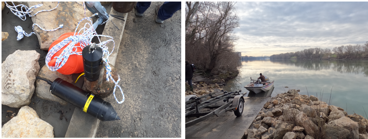
Figure 3 : A gauche : Photographie d'un HR3 (en bas) et TBR800 sur un poids avec la corde et bouée nécessaire à leur déploiement ; à droite : photographie du bateau utilisée à la mise à l'eau
