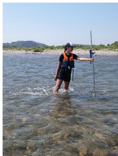
Figure 2 : Mesure au courantomètre
