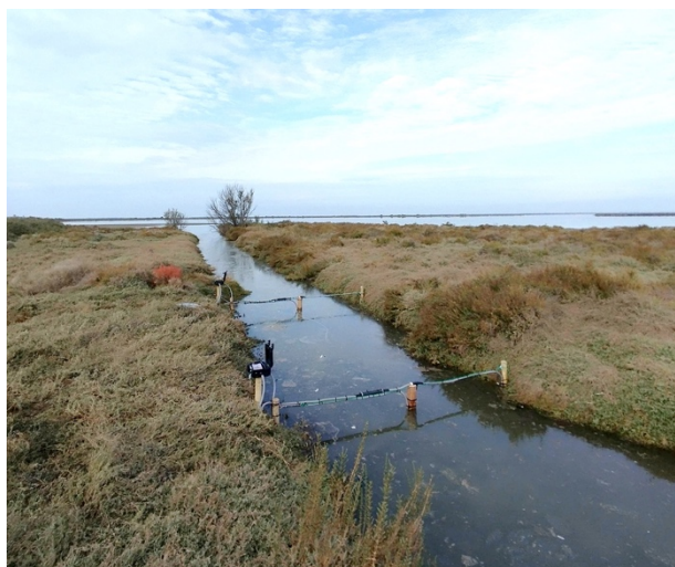
Figure 4 : Dispositif d'antennes RFID mis en place dans le chenal de la Comtesse (© MRM)
