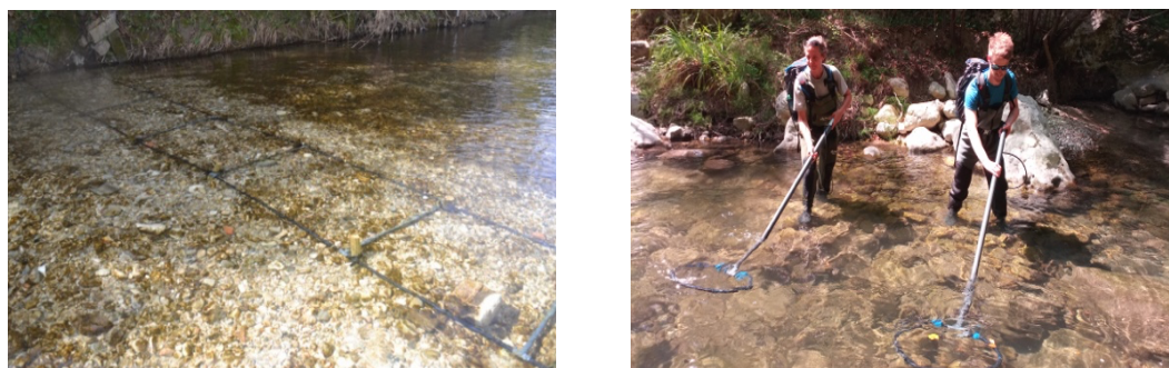
Figure 2 : A gauche, une antenne fixe de Bugadière. A droite, les antennes mobiles pour le Tracking-Mobile
