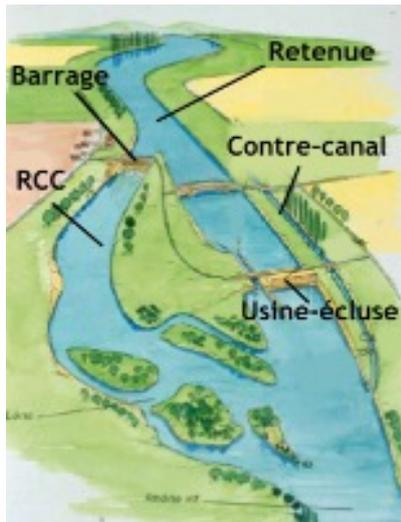
Figure 2 : Alimentation d'une usine via un canal de dérivation. Source : CNR
