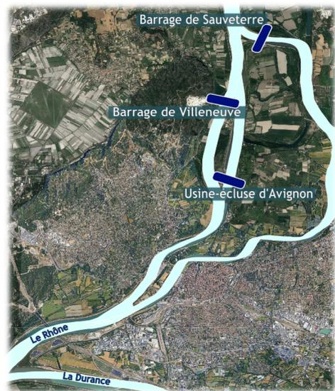
Figure 7 : Configuration de l'aménagement hydroélectrique d'Avignon-Sauveterre
