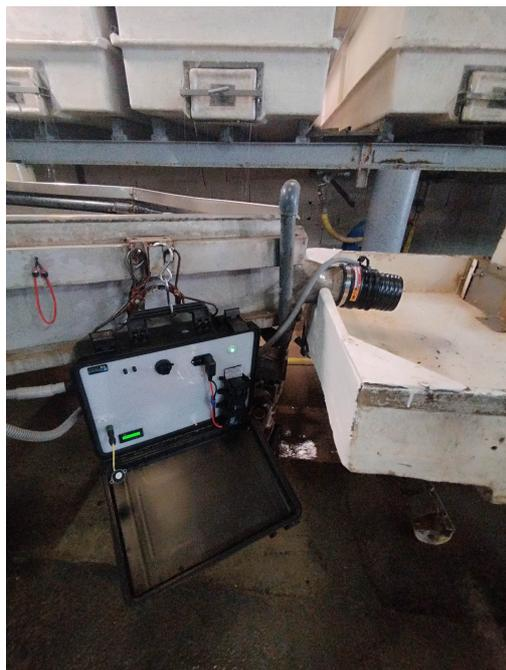
Figure 6 : Dispositif d'antenne RFID mis en place sur une table de tri chez le mareyeur Eurogéal
