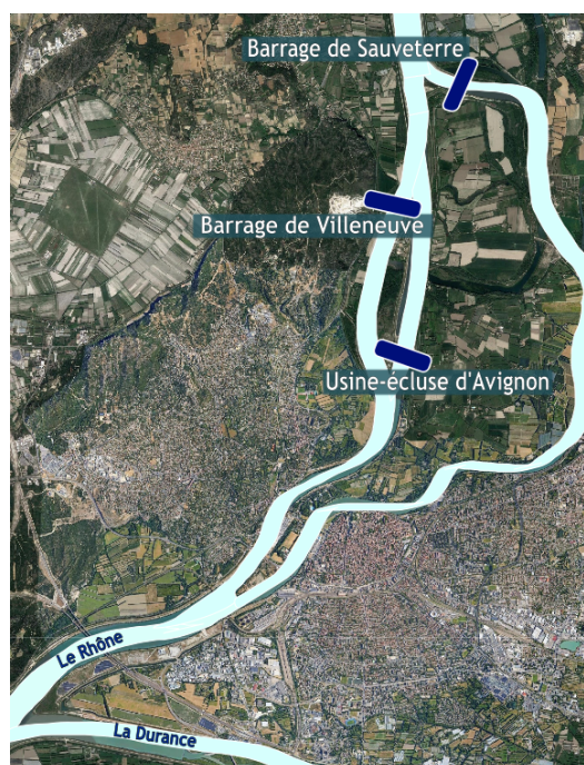
Fig.7 : Configuration de l'aménagement hydroélectrique d'Avignon
