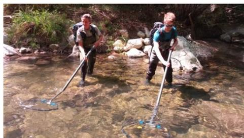
Figure 2 : A gauche, une des antennes fixes installées dans le lit de la Cagne. A droite, les antennes mobiles utilisées lors des prospections à pied.
