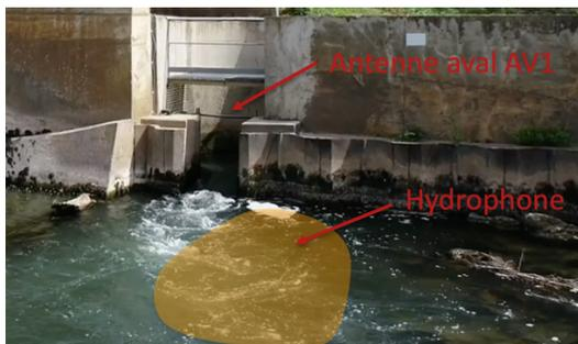
Figure 6 : Localisation de l'antenne aval AV1 et de l'hydrophone filaire. La zone en orange représente une supposition de son aire de captation
