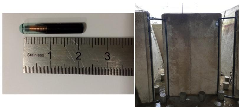
Figure 3 : Exemple de Pit-Tag de 23 mm (Source : MRM) et d'une antenne de détection (Source : profish)
