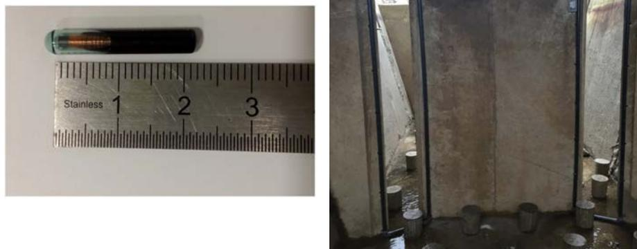
Figure 7 : Exemple de Pit-Tag de 23 mm (Source : MRM) et d'une antenne de détection (Source : profish)
