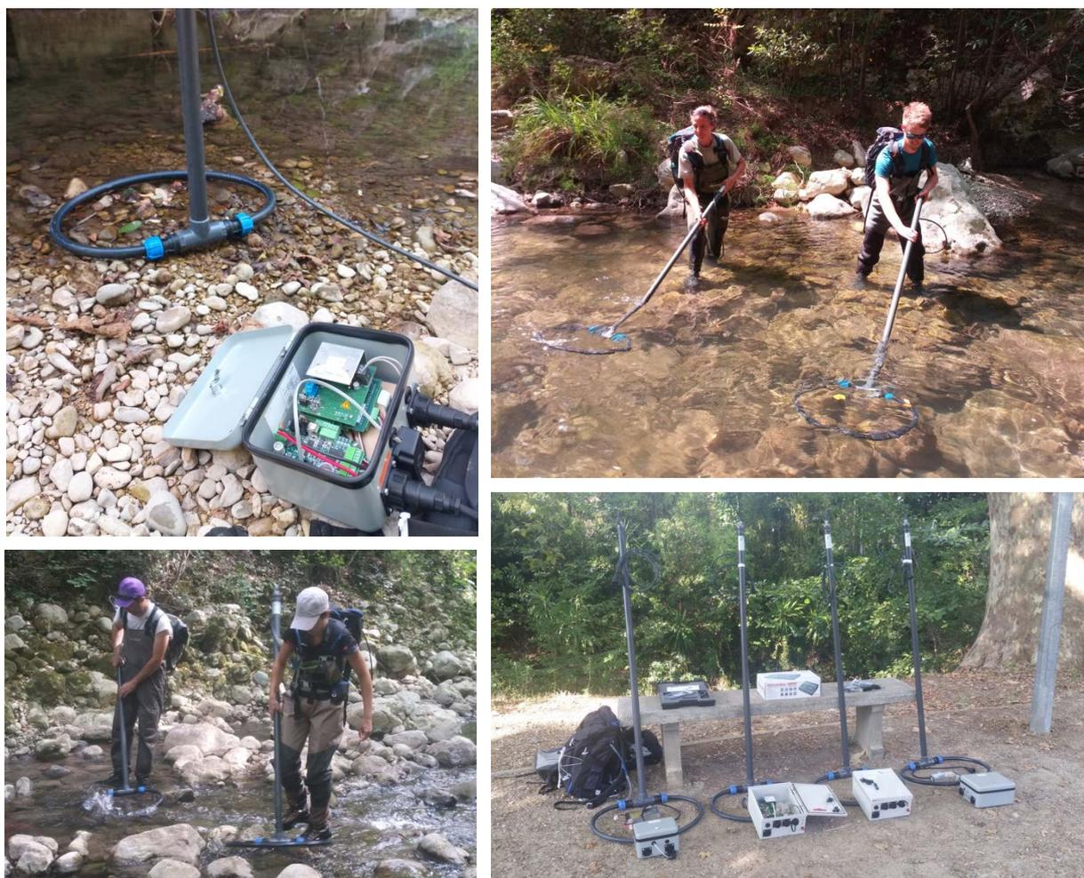
Figure : Les 4 antennes mobiles de l'Association, utilisées en 2019 et 2020 sur la Cagne (© MRM)
