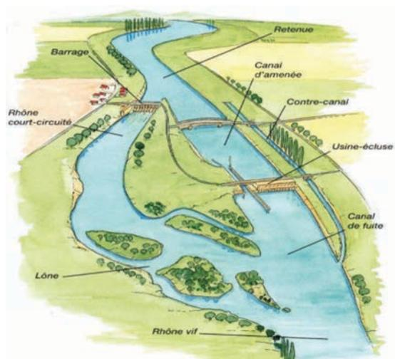
En situation hydrologique normale, le canal d'amenée capte l'essentiel du débit qui est turbiné par la centrale hydroélectrique au fil de l'eau et est restitué au Rhône en aval par le canal de fuite. Le barrage laisse passer, quant à lui, un débit minimal garanti pour alimenter le Rhône court-circuité (ou vieux Rhône). Au-delà du débit d'équipement de la
