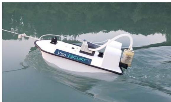
Figure 5 : Prélèvement ADNe en cours grâce au *vigiBOAT* sur le Rhône © CNR
