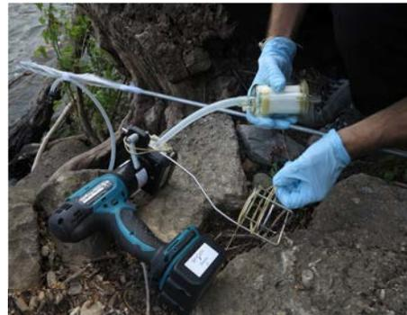
Figure 1 : Matériel de prélèvement ADNe
